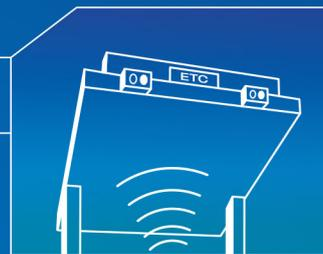
料金所に設置されたアンテナと車載機との間を5.8GHz帯の電波により情報をやり取りし、自動的に料金を収受するシステムです。
